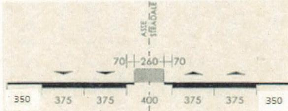
Sezione indicativa, non comprensiva degli spazi laterali di completamento e protezione della sede stradale, da verificare con la vigente normativa
