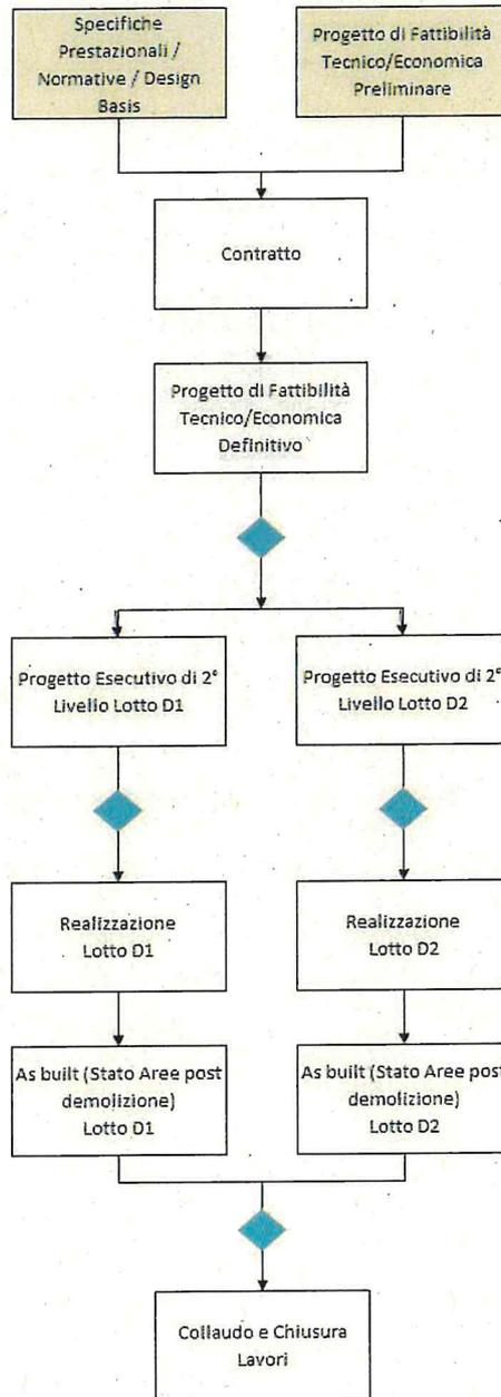
Figura 4.2: Diagramma a Blocchi del Progetto di Demolizione
