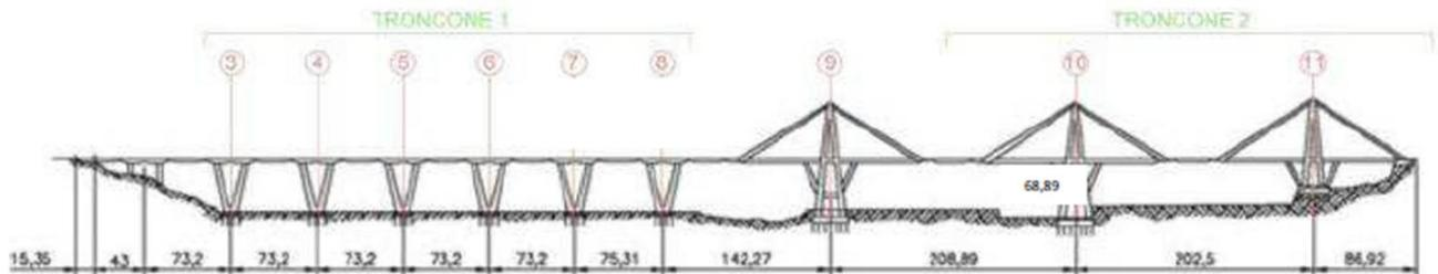
Figura 35 Elementi strutturali oggetto di demolizione (estratto da progetto)
