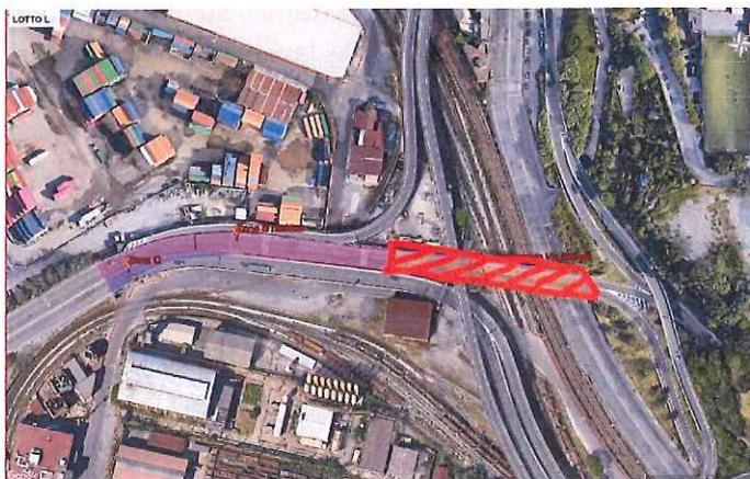
A causa delle gravi criticità strutturali riscontrate, riconducibili allo stato di danneggiamento localizzato e al degrado di alcuni elementi strutturali, è stato deciso di procedere con la demolizione di una porzione del viadotto ed il rifacimento ex novo del cavalca ferrovia su Via Siffredi, in luogo di un consolidamento sulle campate del viadotto escluse dalle demolizioni.
