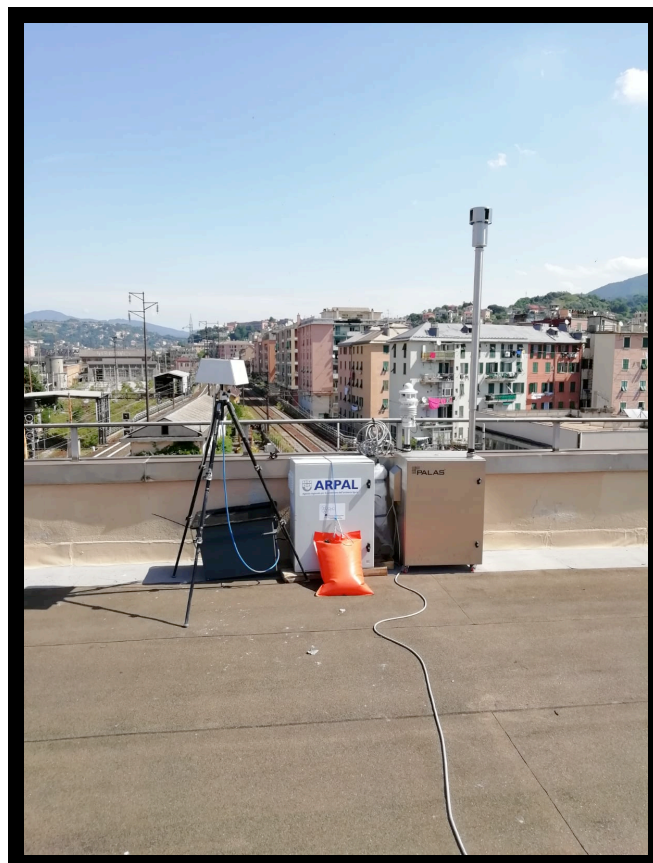
Demolizione Viadotto ViPolcevera Monitoraggio fibre aerodisperse di amianto post esplosione
