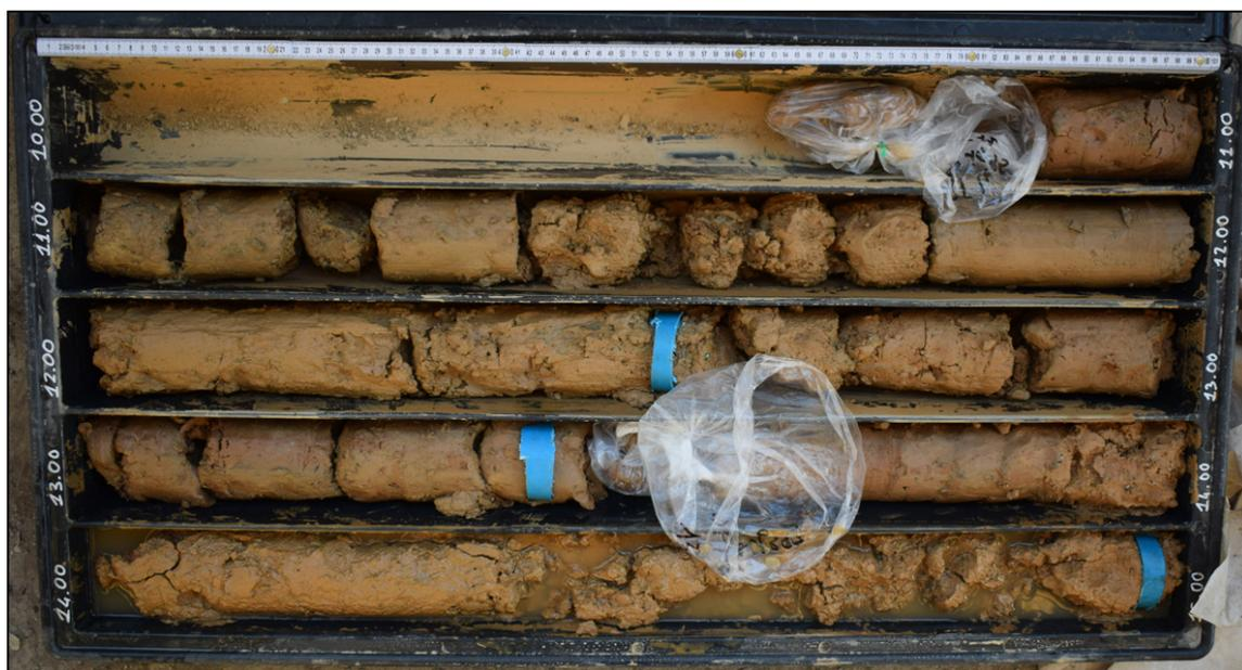
**Figura 65:** Sondaggio 14, carote da -10,00 a -15,00 metri
