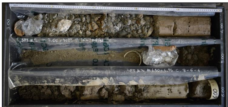
Figura 16: Sondaggio 3, carote da -3,00 metri a -6,00 metri
