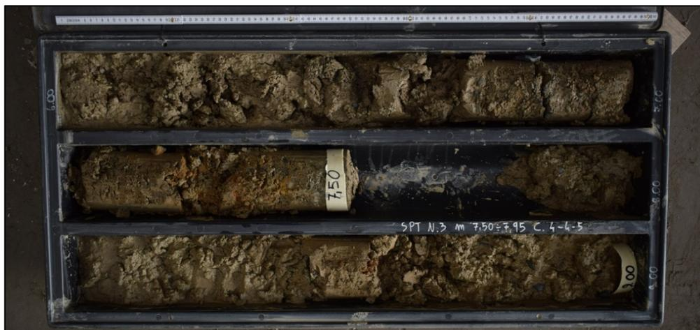
Figura 7: Sondaggio 1, carote da -6,00 a -9,00 metri
