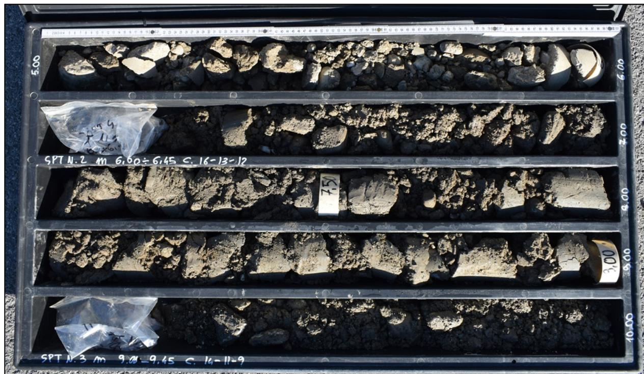
Figura 22: Sondaggio 4, carote da -5,00 a -10,00 metri
