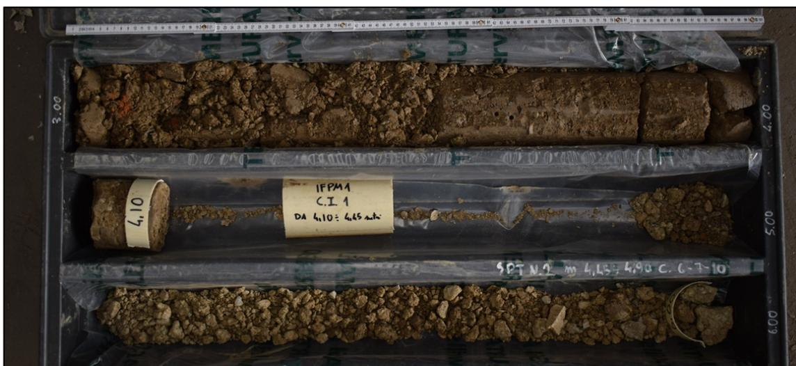
Figura 6: Sondaggio 1, carote da -3,00 a -6,00 metri
