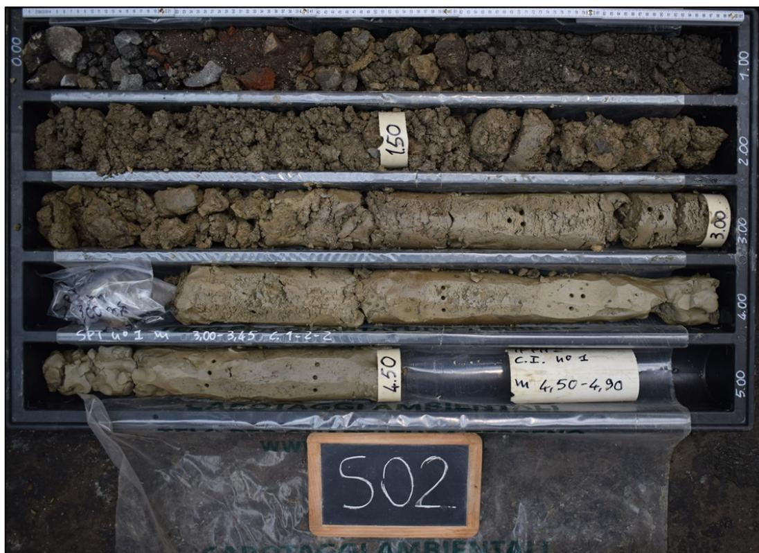
Figura 11: Sondaggio 2, carote da 0,00 a -5,00 metri
