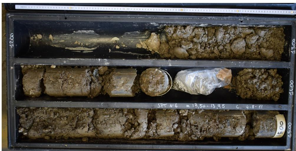
Figura 19: Sondaggio 3, carote da -12,00 metri a -15,00 metri
