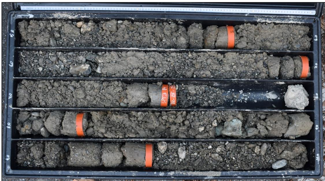
Figura 44: Sondaggio 9, carote da -5,00 a -10,00 metri
