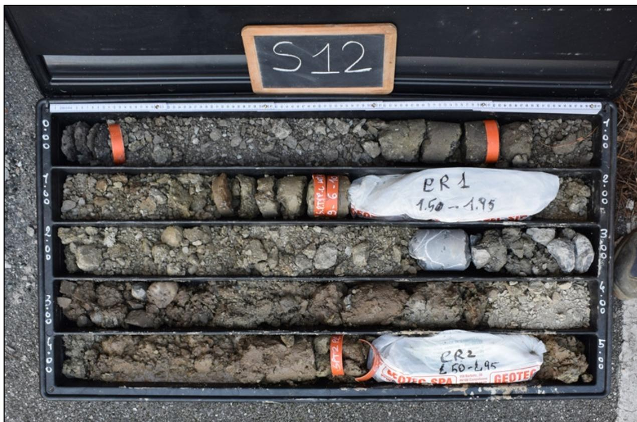
Figura 55: Sondaggio 12, carote da 0,00 a -5,00 metri
