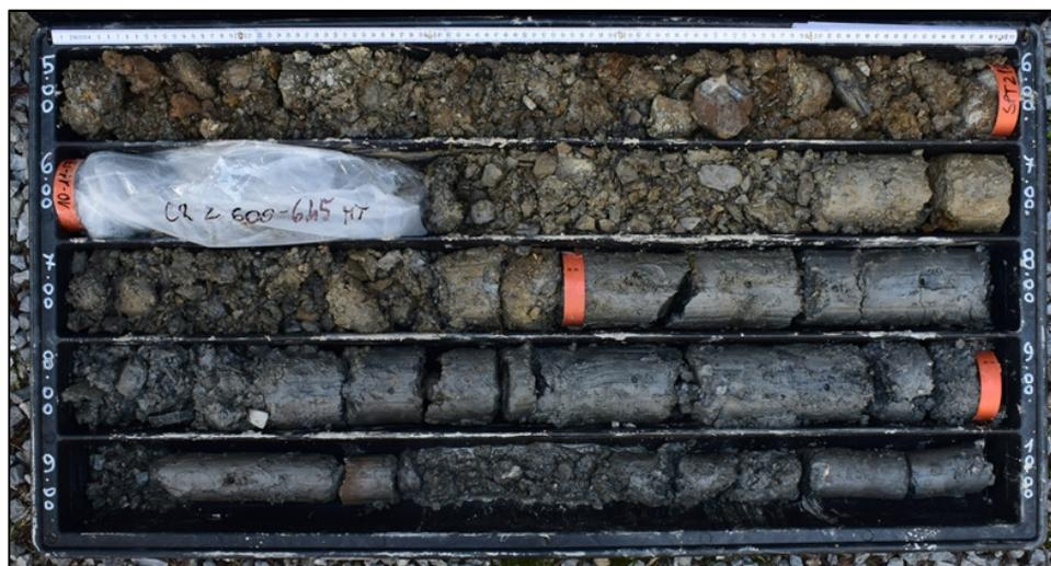
Figura 68: Sondaggio 15, carote da -5,00 a -10,00 metri
