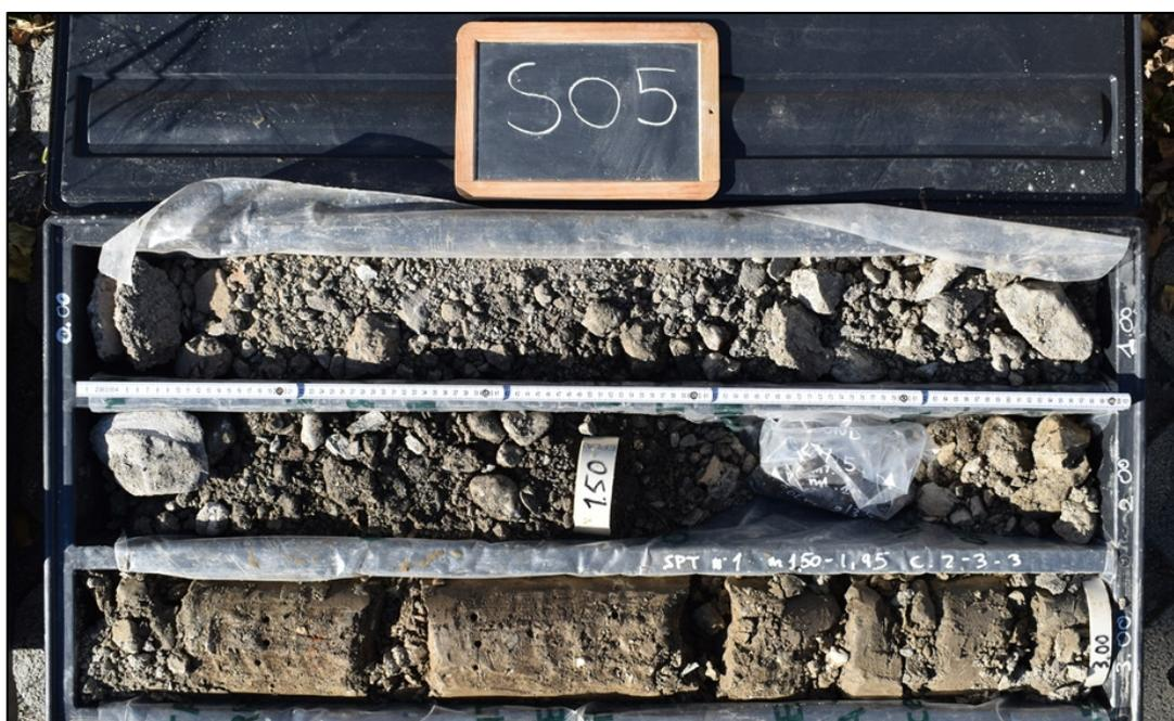
Figura 25: Sondaggio 5, carote da 0,00 a -3,00 metri
