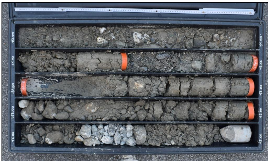
Figura 53: Sondaggio 11, carote da -10,00 a -15,00 metri
