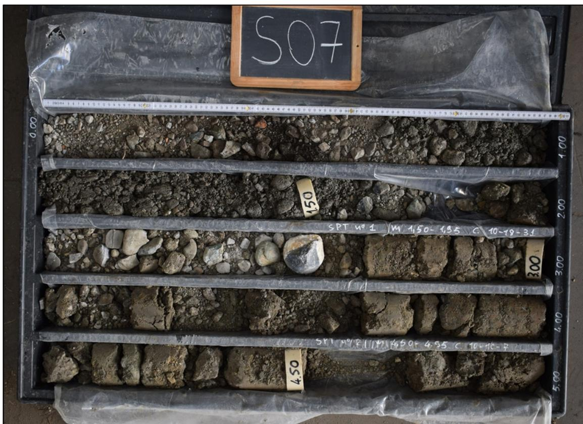
Figura 35: Sondaggio 7, carote da 0,00 a -5,00 metri
