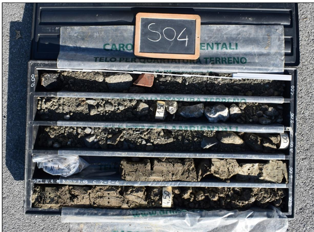
Figura 21: Sondaggio 4, carote da 0,00 a -5,00 metri
