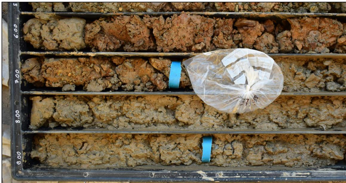
**Figura 64:** Sondaggio 14, carote da -5,00 a -10,00 metri
