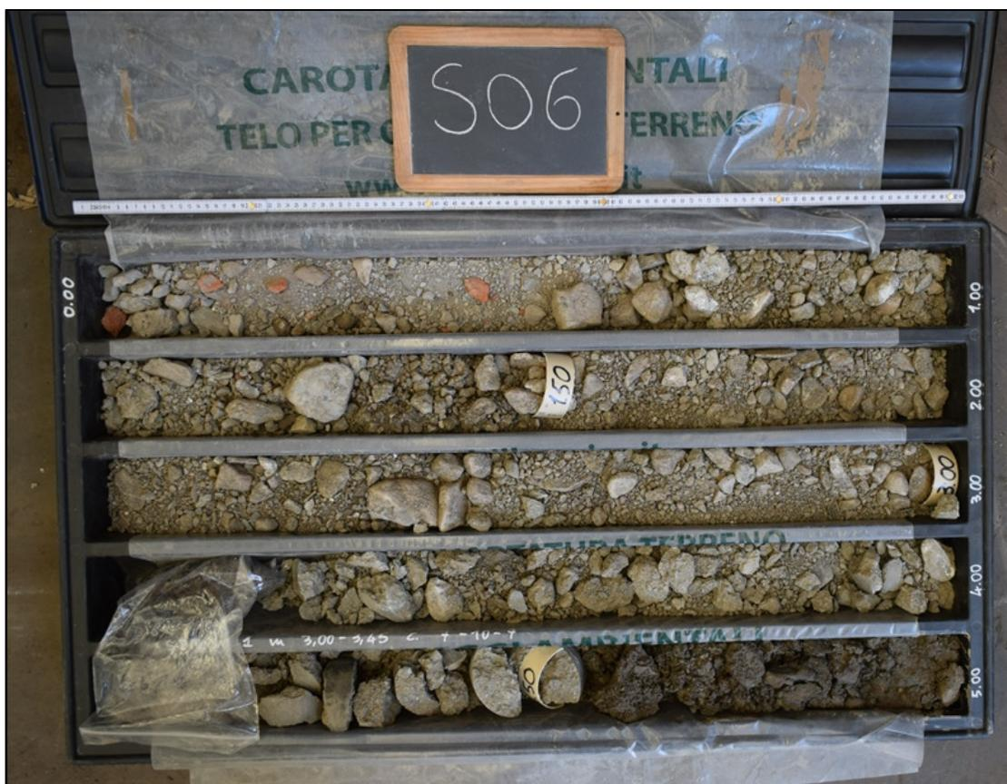
Figura 31: Sondaggio 6, carote da 0,00 a -5,00 metri
