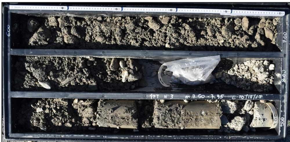
Figura 27: Sondaggio 5, carote da -6,00 a -9,00 metri
