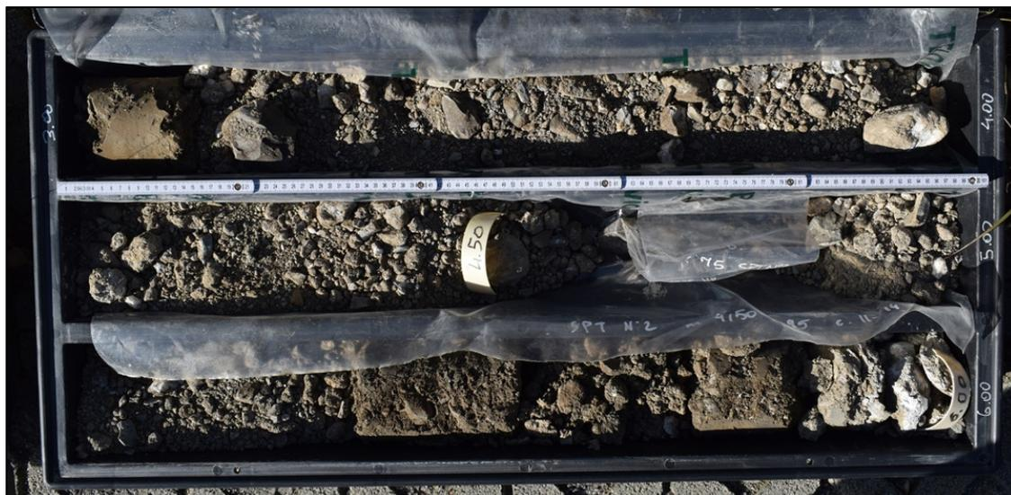
Figura 26: Sondaggio 5, carote da -3,00 a -6,00 metri
