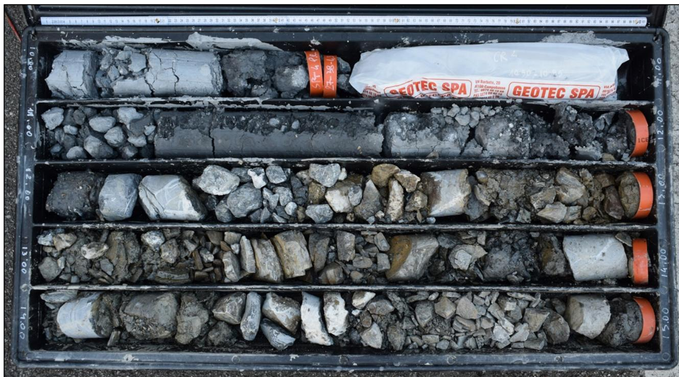
Figura 57: Sondaggio 12, carote da -10,00 a -15,00 metri
