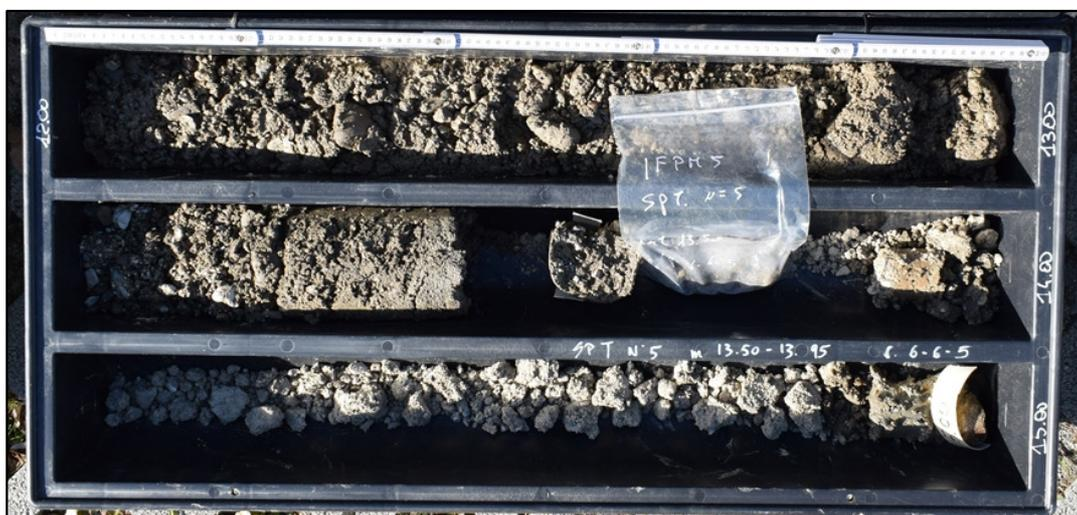
Figura 29: Sondaggio 5, carote da -12,00 a -15,00 metri
