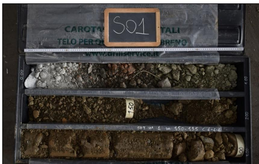
Figura 5: Sondaggio 1, carote da 0,00 a -3,00 metri
