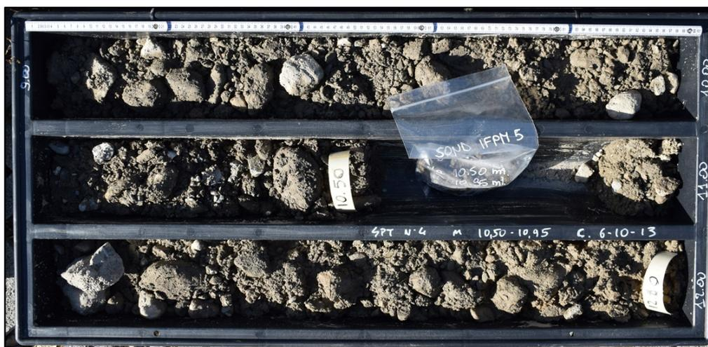
Figura 28: Sondaggio 5, carote da -9,00 a -12,00 metri
