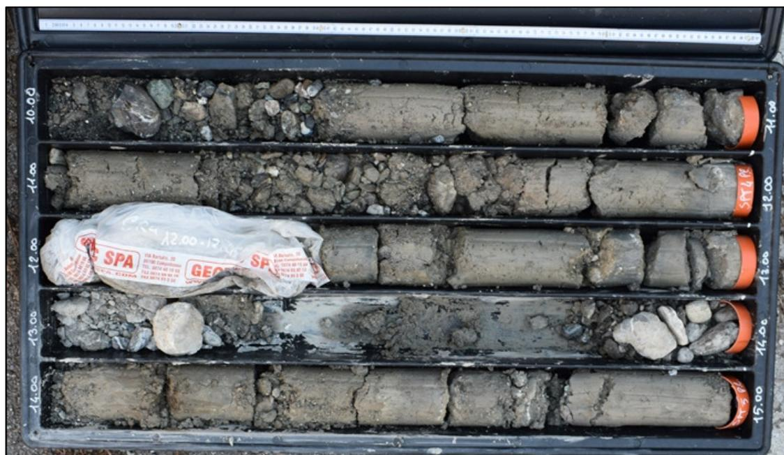
Figura 61: Sondaggio 13, carote da -10,00 a -15,00 metri
