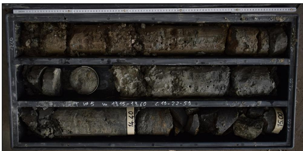
Figura 9: Sondaggio 1, carote da -12,00 a -15,00 metri
