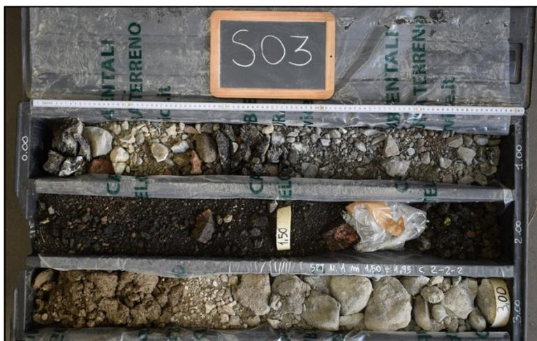
Figura 15: Sondaggio 3, carote da 0,00 a -3,00 metri
