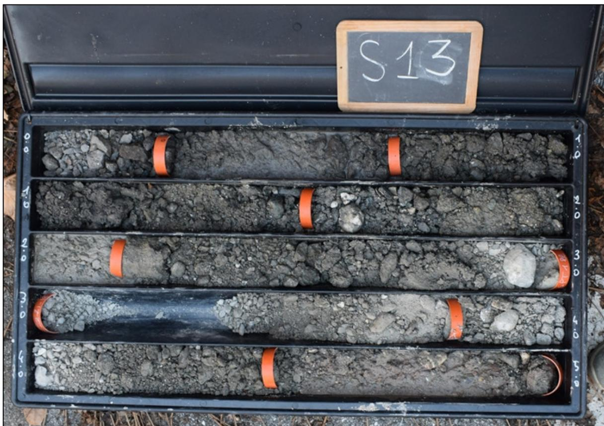
Figura 59: Sondaggio 13, carote da 0,00 a -5,00 metri
