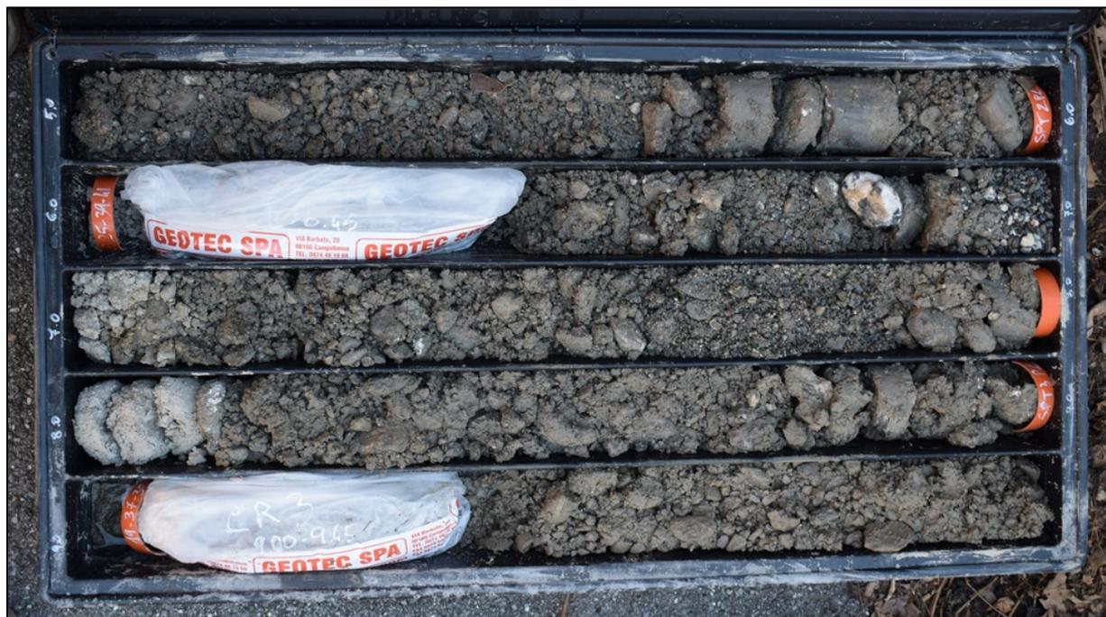
Figura 48: Sondaggio 10, carote da -5,00 a -10,00 metri
